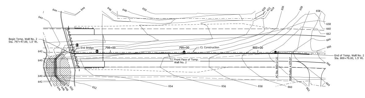
TEMP. RETAINING WALL NO. 2 ELEVATIONS STATION ALONG WALL TOP WALL ELEV. EXIST. GROUND ELEV. 797+47 656.79 652.09 652.19 797+50 656.79 797+75 662.62 652.89 798+00 662.62 653.36 798+25 662.73 653.75 798+50 662.90 654.29 798+75 663.12 654.92 799+00 663.39 655.51 799+25 663.72 655.95 664.10 657.59 799+50 664.54 659.39 799+75 800+00 665.03 660.90 800+25 665.58 662.58 800+50 666.18 664.09 666.70 665.04 800+70
