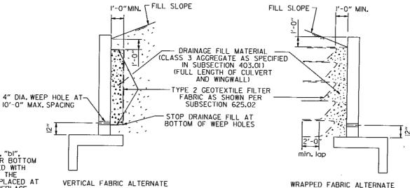
WINGWALL & CULVERT DRAINAGE DETAIL
