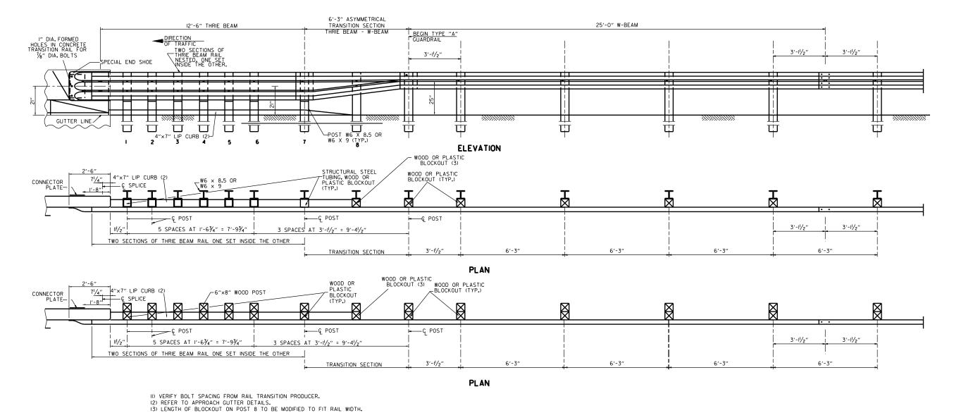
THRIE BEAM GUARDRAIL CONNECTION AT BRIDGE ENDS
